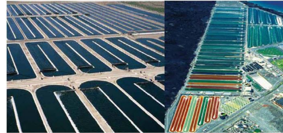
Produzione commerciale di microalghe in open raceway paddle-wheel mixed ponds (Fonte Chisti et al. 2007)
